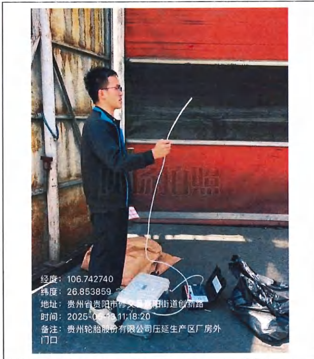
无组织废气现场检测图片（压延生产区厂房）
