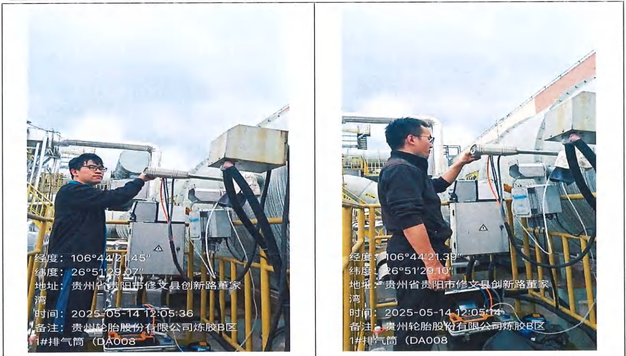
有组织废气现场检测图片（炼胶B区1#进出口（DA008））
