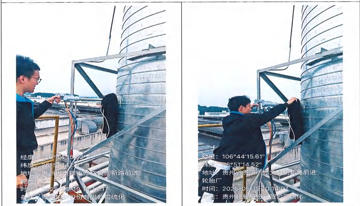
有组织废气现场检测图片（硫化废气排放口(DA015)）
