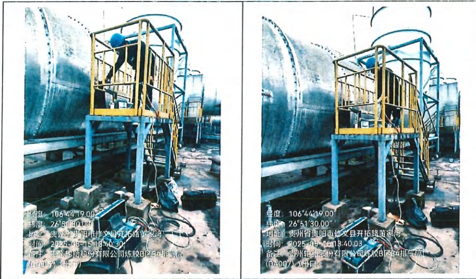
有组织废气现场检测图片（炼胶B区3#排气口(DA007)（出口））
