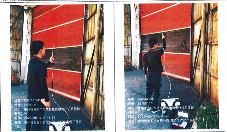
无组织废气现场检测图片（压延生产区厂房）
