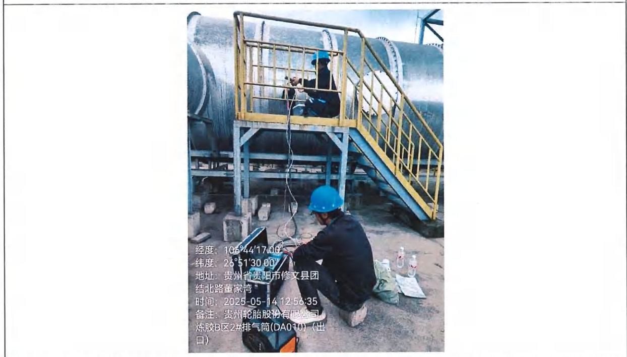
有组织废气现场检测图片（炼胶B区2#排放口(DA010)）
