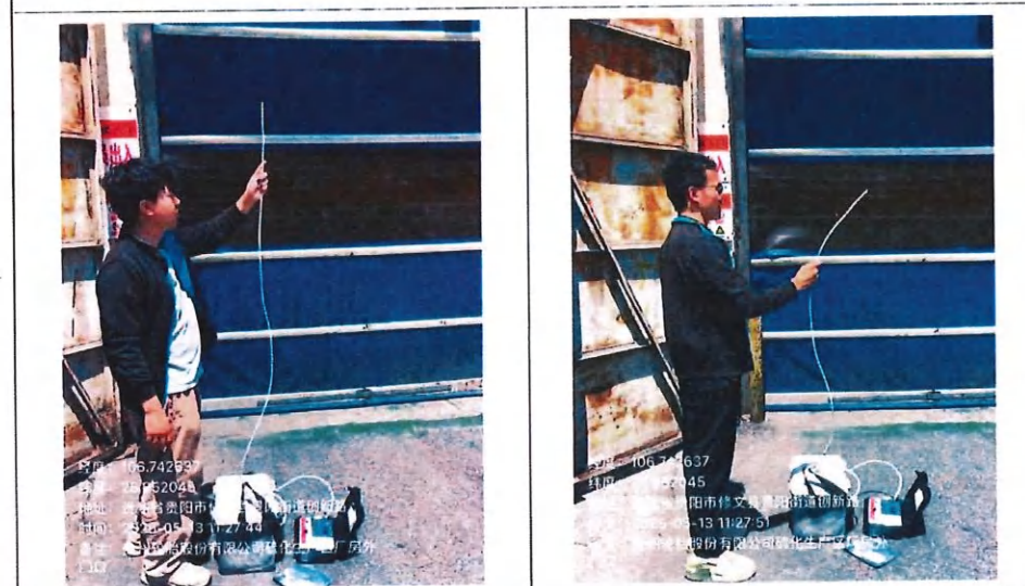
无组织废气现场检测图片（硫化生产区厂房）
