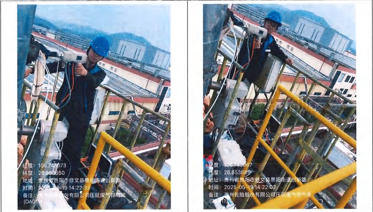
有组织废气现场检测图片（压延废气排放口(DA011)）
