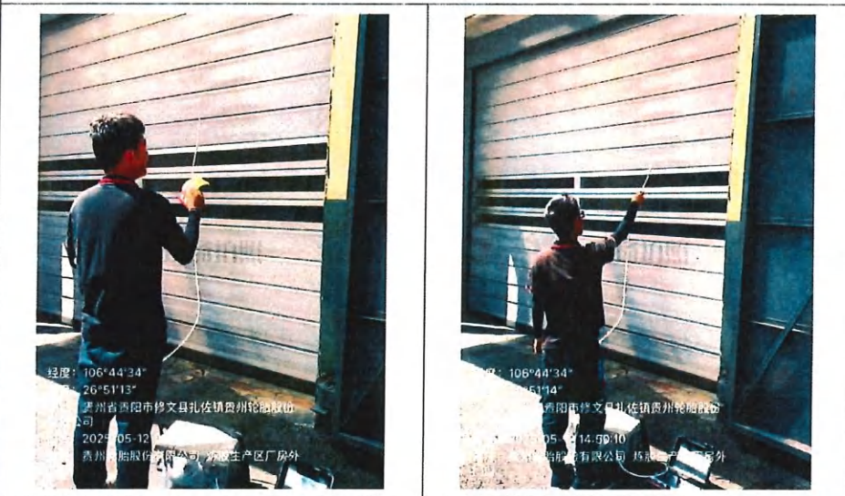
无组织废气现场检测图片（炼胶生产区厂房）
