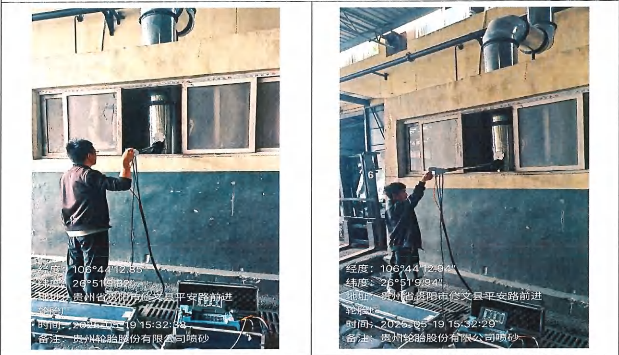
有组织废气现场检测图片（喷砂机粉尘废气排放口DA059）
